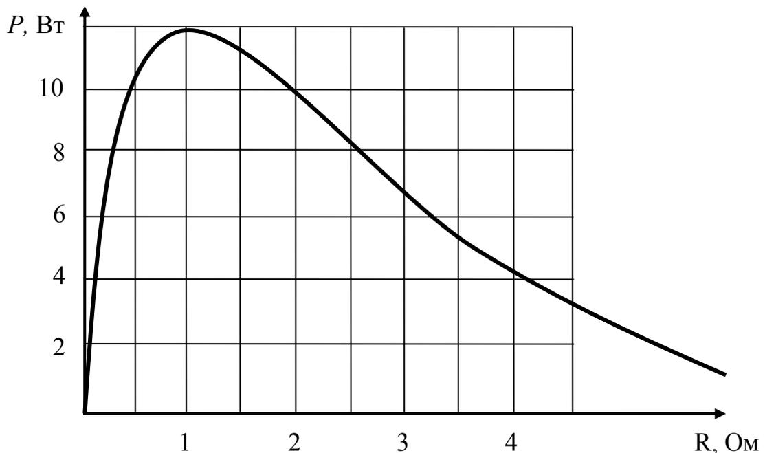
С дальнейшим ростом  $R$  ( $R \rightarrow \infty$ ) полезная мощность стремится к нулю. Коэффициент полезного действия (КПД) источника тока  $\eta$  есть отношение полезной мощности ко всей мощности, выделяемой в цепи
